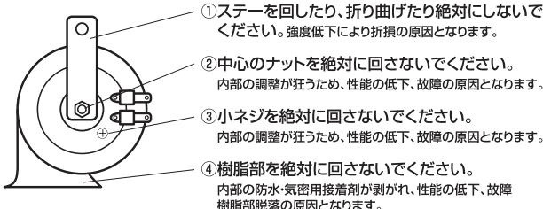
●直接水のかかる場所を避け、ホーンの開口部が必ず下になるように取り付けてください。開口部から水が入ると音が小さくなったり、故障の原因となります。
