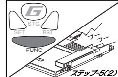
メモ 30秒以内に操作が完了しない場合は、エンジンスタータユニットから「ピーピー」と警告音がし、その後の設定ができません。エンジンキーをOFFに戻し、ステップ3からやり直してください。
