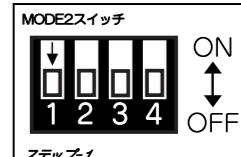
**ステップ 2** 本体のMODE2スイッチメニュー3「ガソリン／ディーゼル切替」を設定します。
